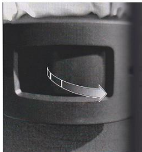
Abb. 7.9 Ersten Flügel der Zweiflügel-Hecktür von innen öffnen und schließen
