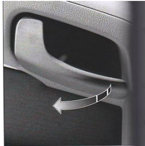
Abb. 7.5 Fahrerkabinenür von Innen öffnen und schließen
